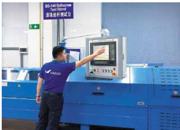
港機部件服務（廈門）的技術人員於原設備製造商的測試台為波音737NG型飛機的襟翼滾珠絲桿進行驗收檢查。
